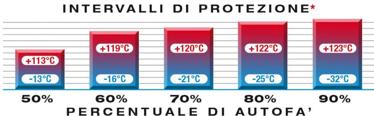
\*TEMPERATURA DI EBOLLIZIONE VALUTATA A 1,8 BAR - PUNTO DI CONGELAMENTO TEST ASTM D1177
